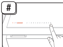
3) # を入力すると Alert と表示され、そのあと 10 秒後に有効となる
